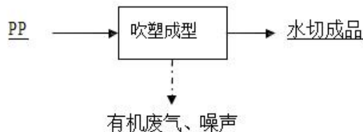
图 7 水切工艺流程及产污环节示意图
