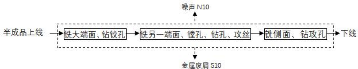
图4-10 过桥箱加工工艺流程及产污环节示意图
